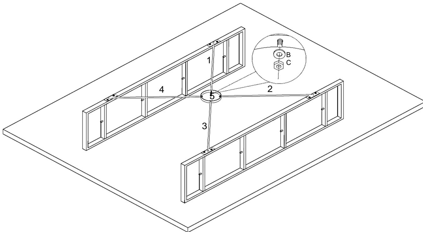
Insérer l'anneau en métal (5) dans les plaques (1, 2, 3, 4) à l'aide des rondelles (B) et écrous (C).
